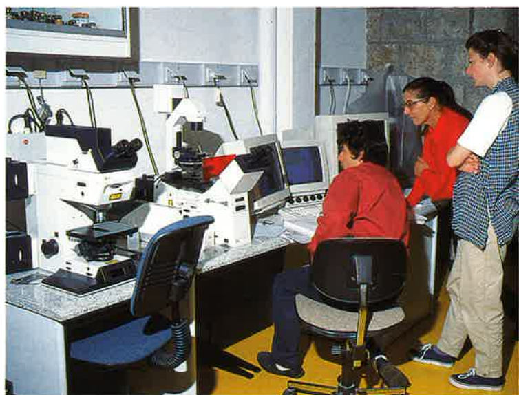
Photo 3: Installation de microscopie confocale. En associant la précision des faisceaux lasers et la puissance de calcul des ordinateurs, le microscope confocal est devenu un outil indispensable à la conduite de recherches de pointe en biologie cellulaire et moléculaire. Il permet de réaliser de véritables tomographies optiques sur du matériel vivant ou fixé. Cette installation, qui comprend un microscope droit et un microscope inversé, est l'une des plus modernes et performantes d'Europe.
