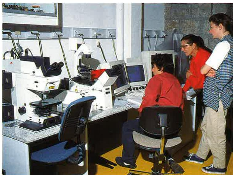
*Photo 3: Installation de microscopie confocale. En associant la précision des faisceaux lasers et la puissance de calcul des ordinateurs, le microscope confocal est devenu un outil indispensable à la conduite de recherches de pointe en biologie cellulaire et moléculaire. Il permet de réaliser de véritables tomographies optiques sur du matériel vivant ou fixé. Cette installation, qui comprend un microscope droit et un microscope inversé, est l'une des plus modernes et performantes d'Europe.*
